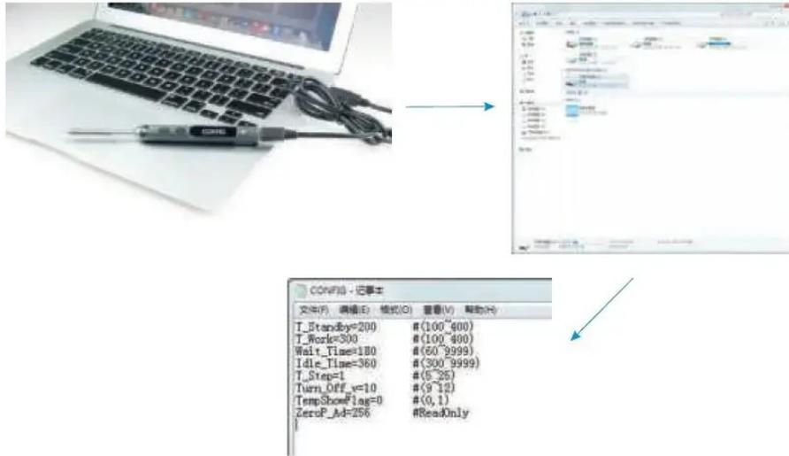
Connectez le TS100 à votre PC avec un câble de données USB, OLED affichera "CONFIG" et signifie qu'il est en mode réglage. Ouvrez config.txt file depuis la clé USB, définissez les paramètres par défaut.
