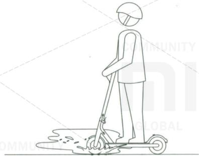
Il est interdit de rouler dans les flaques, qui dépasse la profondeur de 2 cm;
